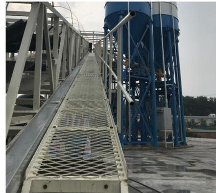
1. L'angle incliné est de  $30^\circ$ , la longueur du tapis transporteur est environ de 25m avec l'appareil de tension.
