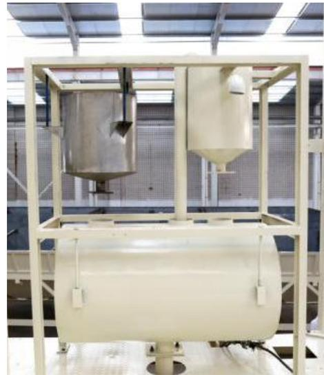
1. Une(1) trémie de pesage à eau, capacité est de 500kg, le pesage est effectué par le capteur précis, le déchargement est contrôlé par le système de commande.
