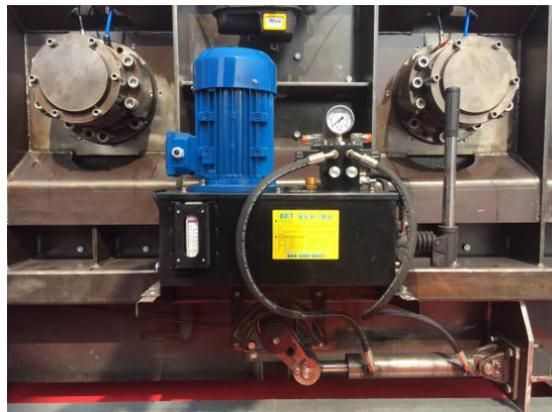
L'ouverture de la porte de déchargement adopte le mode hydraulique.comparé à la ouverture pneumatique(cylindre pneumatique),l'ouverture hydraulique est plus puissante et fiable,parce que en temps froid, la vapeur d'eau dans le cylindre se condensera, ce qui empêchera la porte de décharge de s'ouvrir ou de se fermer correctement, mais ce n'est pas le cas des cylindres hydrauliques.
