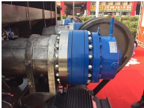
Adopter le réducteur planétaire, la puissance du moteur de mélange est  $2 \times 37 \text{ kW}$ , haute synchronisation. Le réducteur planétaire et le moteur est relié par le courroie, ce qui peut protéger le réducteur en cas de blocage.
