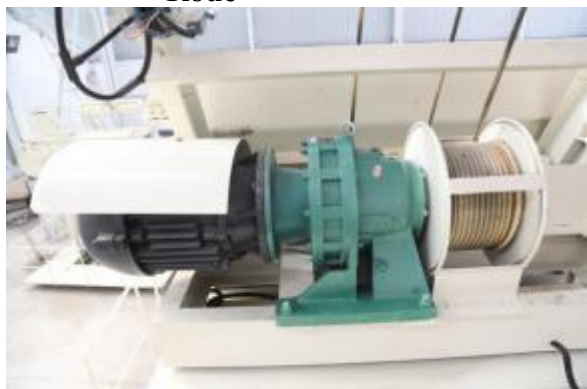
Moteur de levage
