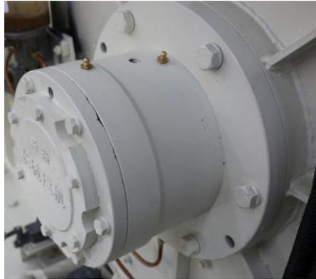
Le joint d'extrémité d'arbre est constitué d'un joint à 5couches. Il est facile à assembler, les joints principaux sont directement pré-assemblés, le tout peut être remplacé et la maintenance est pratique. La durée de vie n'est pas inférieure à 120 000 lots.
