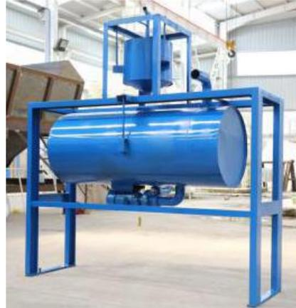
Une(1) trémie de pesage à eau, capacité est de 400kg. Le pesage est effectué par le capteur précis, le déchargement est contrôlé par le système de commande.
