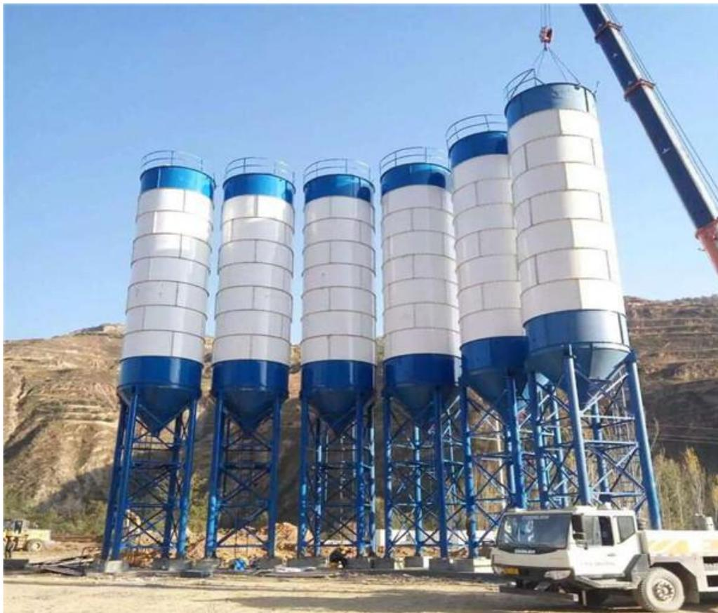
La capacité et la quantité du silo à ciment peuvent être choisis selon le besoin du client. Le silo à ciment de 100t, diamètre est de 3m, longueur est de 12m, poids est de 5.7t. l'épaisseur des tôles: Part inférieure: 4.5mm. Part moyenne: 2.75mm. Part supérieure: 3.5mm.
