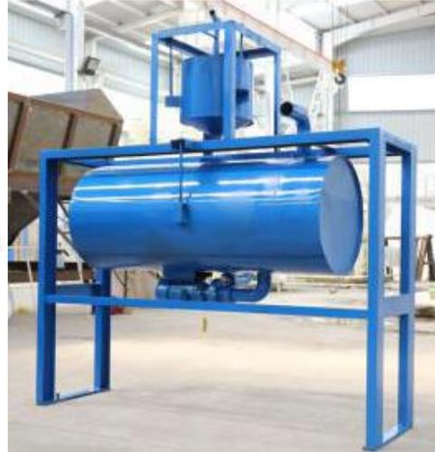
Une(1) trémie de pesage à eau, capacité est de 300kg. Le pesage est effectué par le capteur précis, le déchargement est contrôlé par le système de commande.
