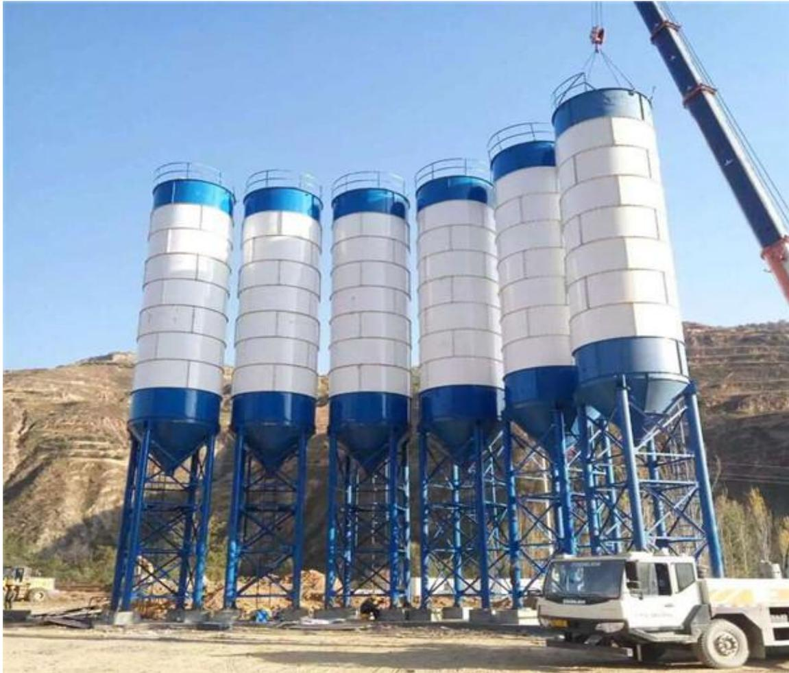
La capacité et la quantité du silo à ciment peuvent être choisi selon le besoin du client.le silo à ciment de 100t , diamètre est de 3m, longueur est de 12m,poids est de 5.7t.l'épaisseur des tôles:Part inférieur:4.5mm. Part moyenne:2.75mm. Part supérieur:3.5mm.
