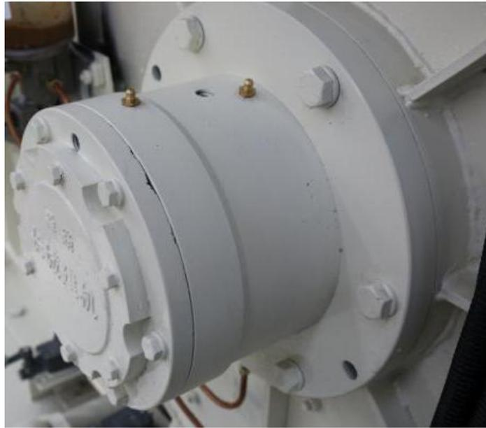
Le joint d'extrémité d'arbre est constitué d'un joint à 5 couches. Il est facile à assembler, les joints principaux sont directement pré-assemblés, le tout peut être remplacé et la maintenance est pratique. La durée de vie n'est pas inférieure à 120 000 lots.
